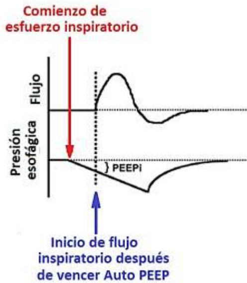
Figura 45.13. Efectos de Auto PEEP sobre el disparo del ventilador por sensibilidad en modo asistido.
